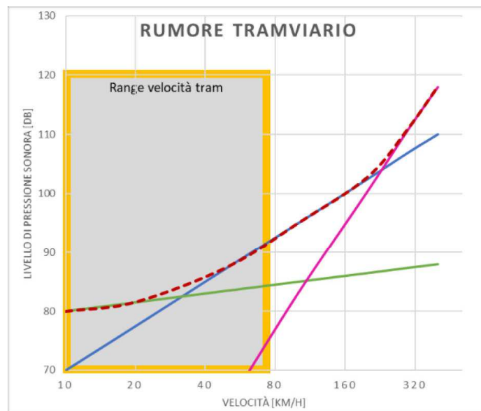
Figura 1: Rumore tranviario: rumore del sistema di trazione (verde), rumore di rotolamento (blu), rumore aerodinamico (fuxia), totale (rosso tratteggiato).
