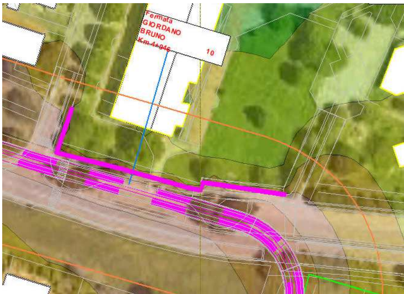
Barriera H = 4 m (linea continua in magenta) presso la scuola primaria Fra' Ristoro di Campi B. - IC M.Hack (Ric. sen. n. 3)
