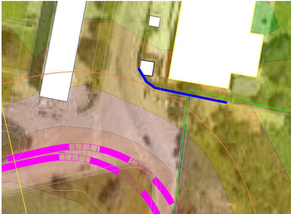
Barriera H = 3 m (linea continua in blu) presso la scuola materna Capuana (Ric. sen. n. 9)
