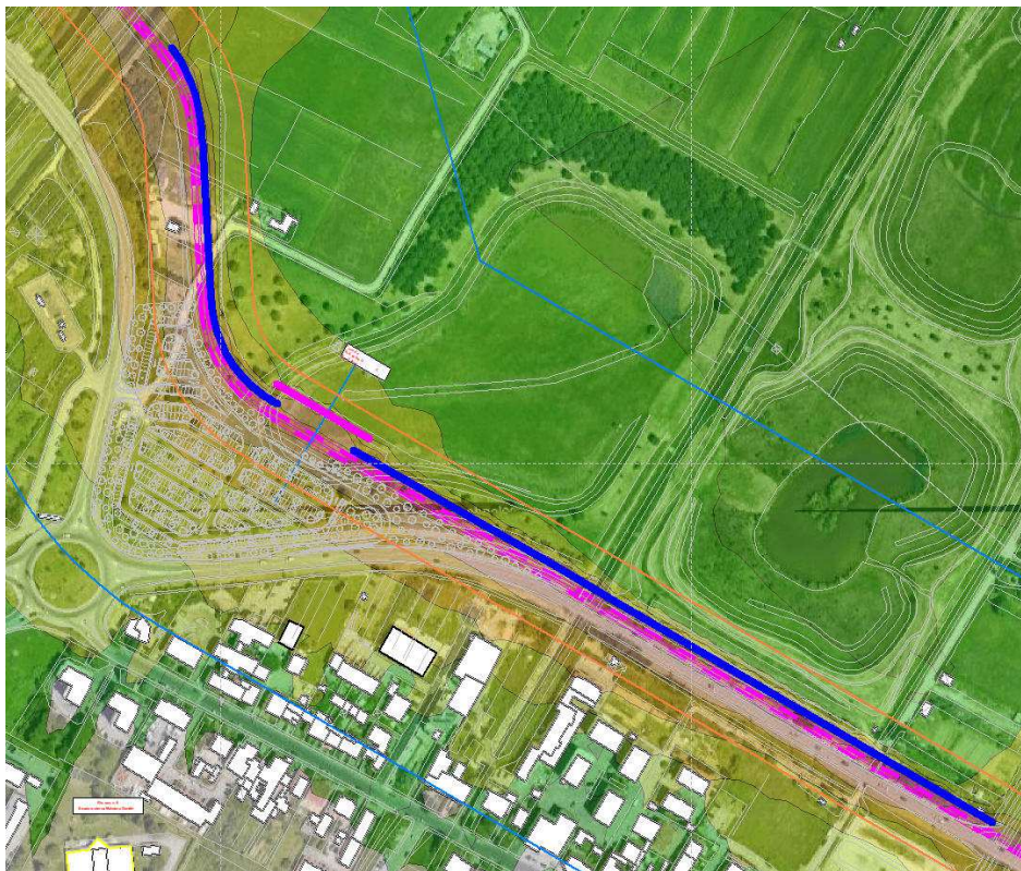
Barriere H = 3 m (linea continua in blu) e H = 4 m (linea continua in magenta) presso l'area ZSC Natura 2000
